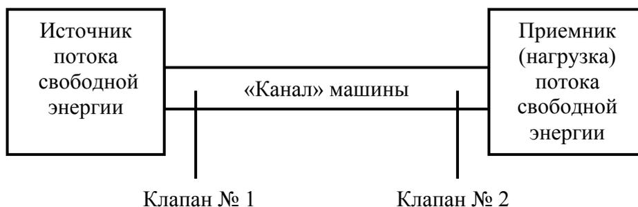
Рис. 2. «Обобщенная» машина как «канал», соединяющий источник мощности с нагрузкой
