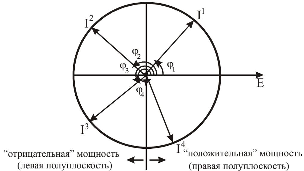
Рис. 7. «Фазовые соотношения» на «приемном конце линии»
