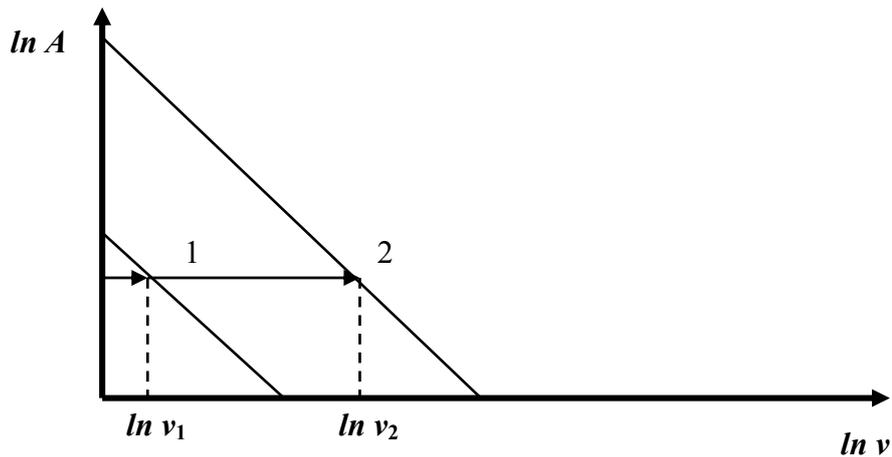
Рис. 5. Постоянство амплитуды на диаграмме равномоощных машин
