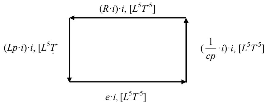
Рис. 9. Уравнение «баланса» мощности как «векторная» диаграмма
