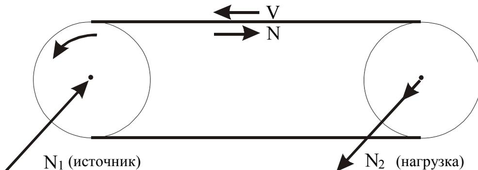
Рис. 6. Модель передачи мощности через приводной ремень
